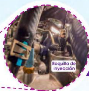
Figura 2. Partes que componen el kit de inyección de bioetanol instalado en Carlab:
