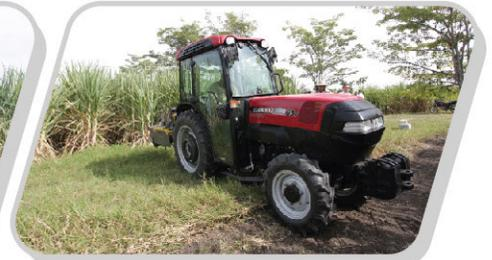
CASE IH ha desarrollado especialmente para caña orgánica el QUANTUM 65V, con 1.060 mm de ancho. Este tractor puede ser utilizado en labores convencionales por su potencia, su despeje, capacidad de alce hidráulico, configuración de motor y caja de velocidades.
