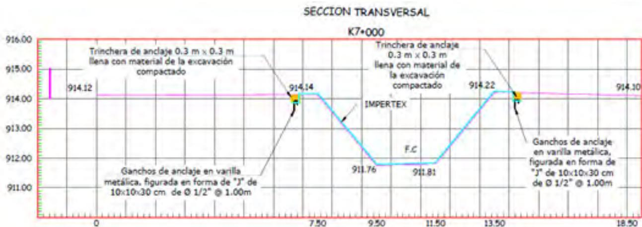
Una vez se tiene la topografía se determina el ancho que debe tener el geotextil garantizando que se cubra en su totalidad
