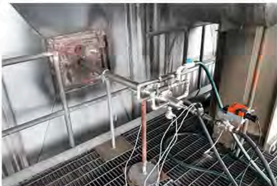
Figura 3. Probeta invasiva para caracterización de depósitos y tasa de incrustación
