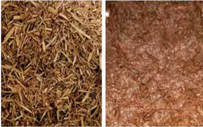
Figura 6. RAC antes y después del pretratamiento de autohidrólisis
